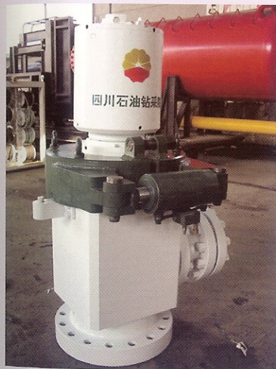
XK35-17.5/35型旋转防喷器
